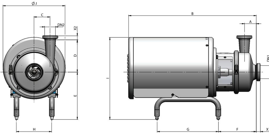
Abmessungen X<sub>1</sub>, X<sub>2</sub>
