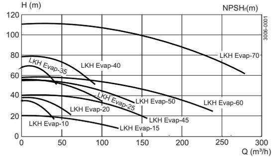
**Achtung:** Mit dem Clear Flow Impeller kann die Leistung bis zu 10% geringer sein als im Leistungsdiagramm dargestellt.
