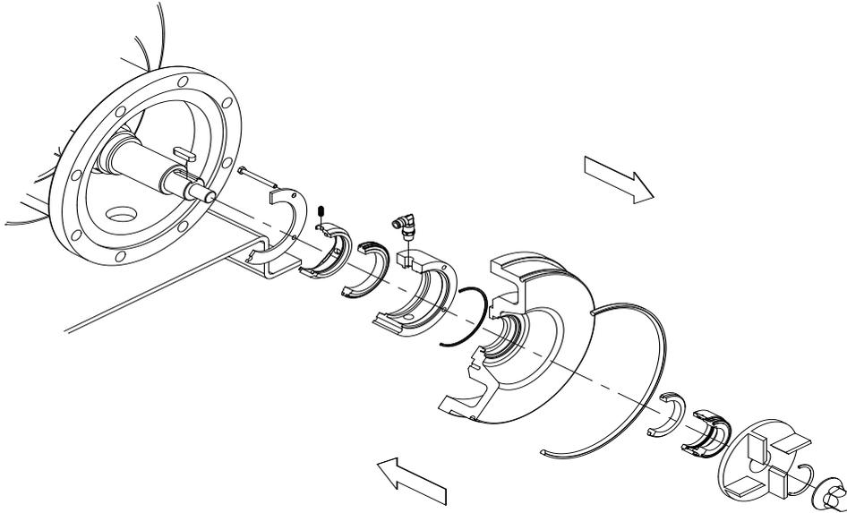
**ACHTUNG!** Beim Einbau der neuen Gleitringdichtung darauf achten, dass die Teile und Dichtungen mit Seifenwasser eingebaut werden, um die Gleitfähigkeit sowohl des stationären als auch des rotierenden Teils auf der Welle zu fördern.
