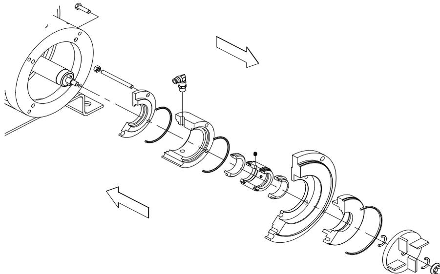
**ACHTUNG!** Beim Einbau der neuen Gleitringdichtung darauf achten, dass die Teile und Dichtungen mit Seifenwasser eingebaut werden, um die Gleitfähigkeit sowohl des stationären als auch des rotierenden Teils auf der Welle zu fördern.
