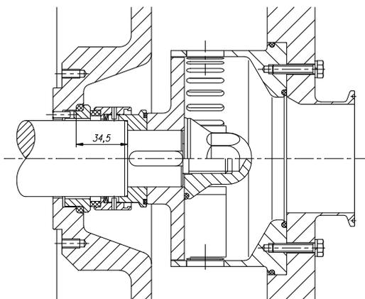
Die Dichtung (80) und den stationären Teil der Gleitringdichtung (08) unter Berücksichtigung des Zapfens in den Deckel (03) einlegen. Den rotierenden Teil der Gleitringdichtung (08) bis zum Anschlag auf die Welle (05) schieben. Das Laufrad (21) auf die Welle schieben und mithilfe der Mutter (45) befestigen. Zuvor die Dichtung (80A) unterlegen.
