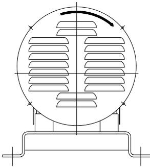
Den Mischermotor kurz anlaufen lassen. Mit Blick von hinten auf den Mischer sicherstellen, dass sich der Motorlüfter im Uhrzeigersinn dreht.
