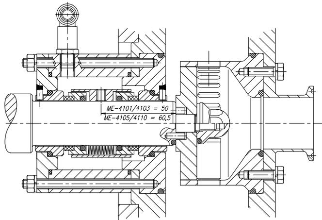
Die Dichtung (80G) und das Laufrad (21) auf die Welle (05) setzen.
