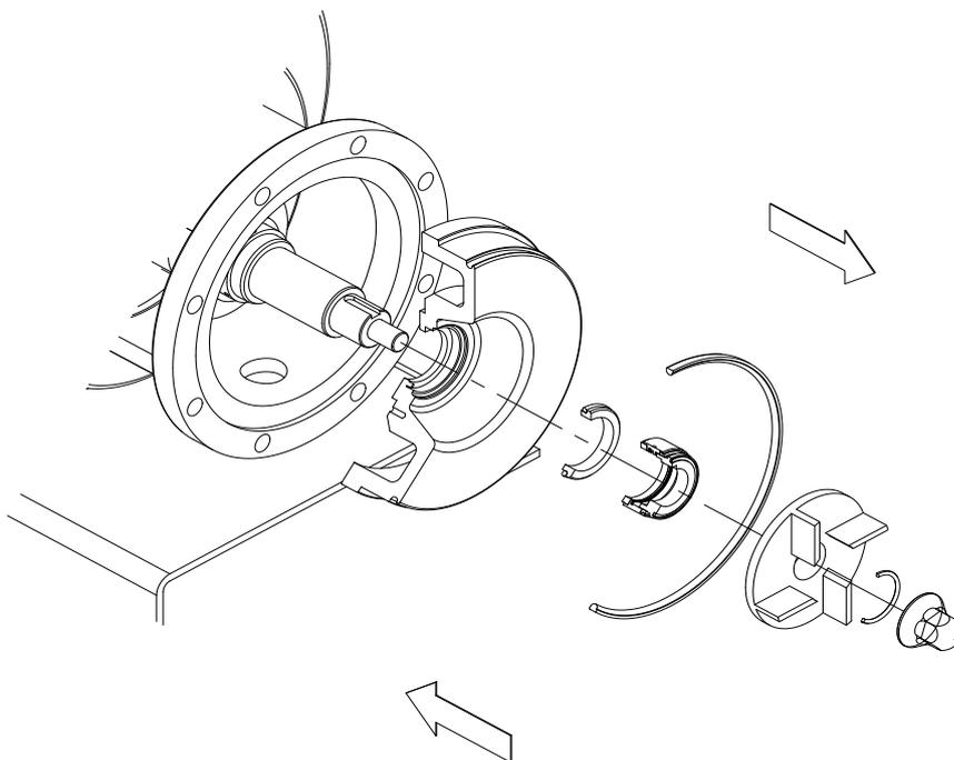
**ACHTUNG! Beim Einbau der neuen Gleitringdichtung darauf achten, dass die Teile und Dichtungen mit Seifenwasser eingebaut werden, um die Gleitfähigkeit sowohl des stationären als auch des rotierenden Teils auf der Welle zu fördern.**
