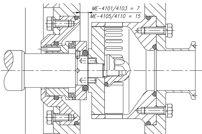
Den rotierenden Teil der Gleitringdichtung (08) bis zum Anschlag auf die Welle (05) schieben, dabei den Schlitz dem Zapfen gegenüberstellen.
