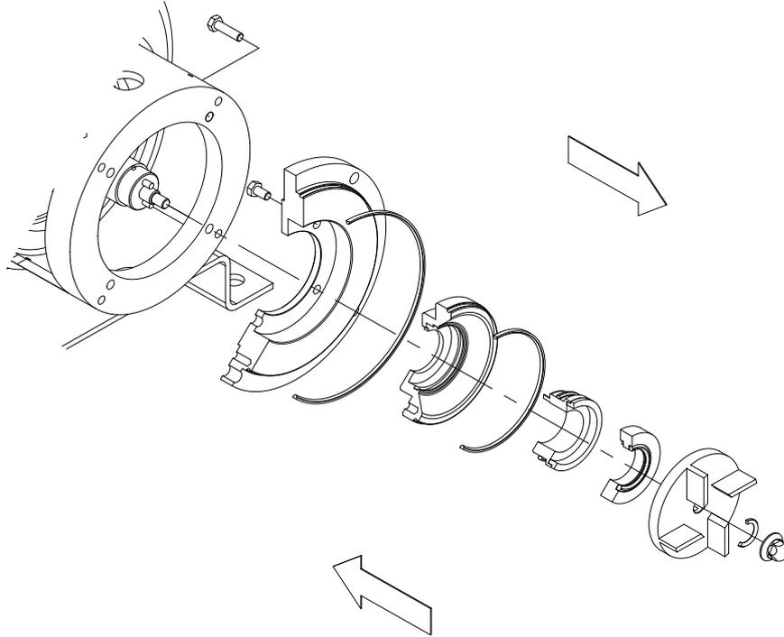
**ACHTUNG! Beim Einbau der neuen Gleitringdichtung darauf achten, dass die Teile und Dichtungen mit Seifenwasser eingebaut werden, um die Gleitfähigkeit sowohl des stationären als auch des rotierenden Teils auf der Welle zu fördern.**
