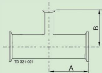
**RACCORD EN T DE RÉDUCTION 3X CLAMP TRI-CLOVER CODE B7RMP ASME BPE CODE DT-4.1.2-8**
