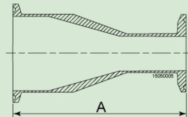
**RÉDUCTION DE SOUDURE CONCENTRIQUE CLAMP/CLAMP TRI-CLOVER CODE B31S-14MP ASME BPE CODE DT-4.1.3-3**
