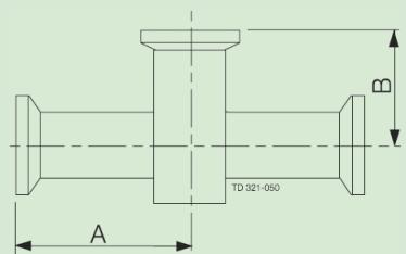
**RACCORD EN T POUR INSTRUMENTS 3XCLAMP TRI-CLOVER CODE B7IMPS ASME BPE CODE DT-4.1.2-11**
