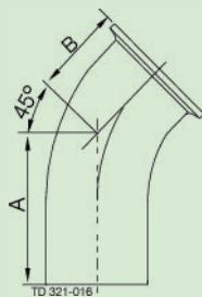
**COUDE 45° SOUDURE X FERRULE CLAMP TRI-CLOVER CODE B2KMW ASME BPE CODE DT-4.1.1-5**
