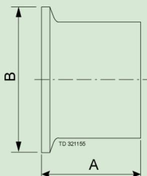
**FERRULE DE SOUDURE MEDIUM / FERRULE CLAMP MEDIUM TRI-CLOVER CODE L14AM ASME BPE
