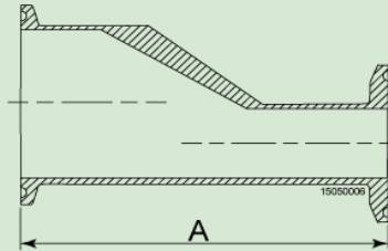
**RÉDUCTION DE SOUDURE EXCENTRIQUE CLAMP/CLAMP TRI-CLOVER CODE B32S-14MP ASME BPE CODE DT-4.1.3-3**
