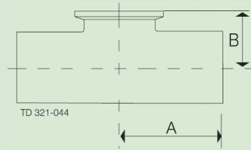
**RACCORD EN T SOUDURE/SOUDURE/CLAMP COURT TRI-CLOVER CODE B7WWMS ASME
