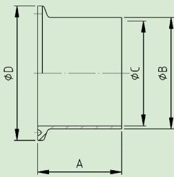
**FERRULE DE SOUDURE LONG TRI-CLOVER CODE BS14AM ASME BPE CODE DT-4.1.4-1 (AVANT DT-22A)**
