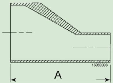
**RÉDUCTION DE SOUDURE EXCENTRIQUE TRI-CLOVER CODE B32S ASME BPE CODE DT-4.1.3-1**
