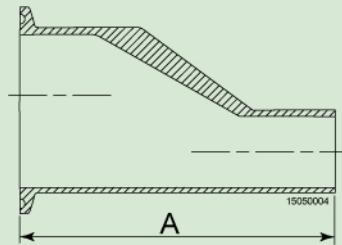
**RÉDUCTION DE SOUDURE EXCENTRIQUE RACCORD /CLAMP TRI-CLOVER CODE B32MS ASME BPE
