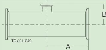
**RACCORD EN T DE RÉDUCTION COURT 3X CLAMP TRI-CLOVER CODE B7RMPS ASME BPE CODE DT-4.1.2-9**
