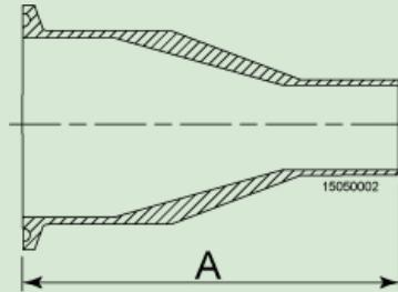
**RÉDUCTION DE SOUDURE CONIQUE CLAMP/SOUDURE TRI-CLOVER CODE B31MS ASME BPE CODE DT-4.1.3-2**
