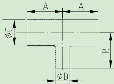
**RACCORD EN T DE RÉDUCTION TRI-CLOVER CODE B7RWWW ASME BPE CODE DT-4.1.2-6**
