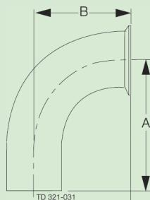
**COUDE 90° SOUDURE X FERRULE CLAMP TRI-CLOVER CODE B2CMW ASME BPE CODE DT-4.1.1-2**
