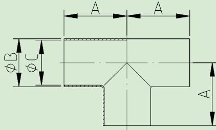
**RACCORD EN T SOUDURE TRI-CLOVER CODE B7WWW ASME BPE CODE DT-4.1.2-1**
