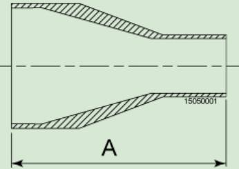
**RÉDUCTION DE SOUDURE CONCENTRIQUE TRI-CLOVER CODE B31S ASME BPE CODE DT-4.1.3-1**
