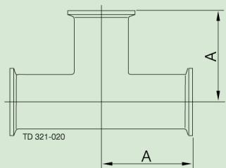
**RACCORD EN T 3X FERRULE CLAMP TRI-CLOVER CODE B7MP ASME BPE CODE DT-4.1.2-4**
