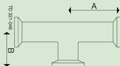
**RACCORD EN T KORT 3X FERRULE CLAMP TRI-CLOVER CODE B7MPS ASME BPE CODE DT-4.1.2-5**
