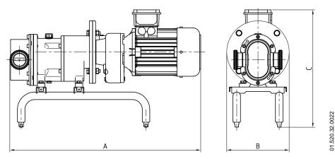
В С kW Pump size Α 0,55 TLS 1-25 0,75 0,75 TLS 1-40 1,1 1,1 TLS 2-40 1,5 1,5 **TLS 2-50** 2,2 2,2/3 TLS 3-50 5,5 **TLS 3-80** 5,5 7,5
