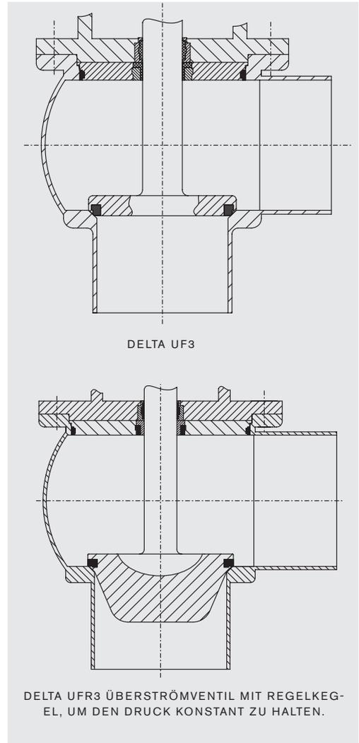
Anwendungsbeispiel Pumpenabsicherung, z.B. UFE34: Oberer Durchgang = Saugseite, unterer Durchgang = Druckseite – kaum Totraum zwischen Gehäuseoberteil und Gehäuseunterteil.
