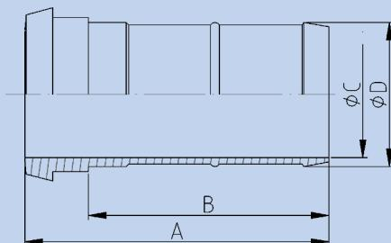
SLANGPUNTSTUK TYPE DIN, DIN 11851
