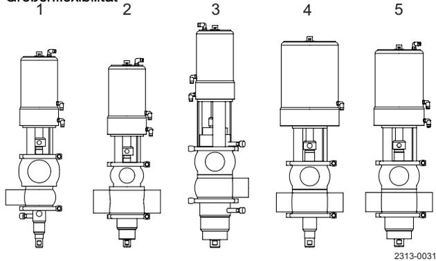
Das Unique Mixproof-Konzept umfasst in beliebiger Kombination Ventilkegel mit oder ohne Balancer, Sitzhub, CIP für Verschlüsse und Leckagekammern.
