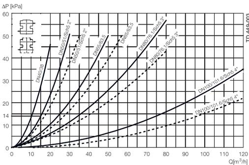
**Abb. 5, Druckabfall-/Leistungsdiagramm, zwischen den Gehäusen.**
