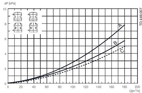
**Abb.6 Druckabfall-/Leistungsdiagramm, durch Gehäuse DN 125, DN 150**
