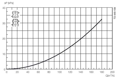
**Abb.7 Druckabfall-/Leistungsdiagramm, zwischen den Gehäusen.**
