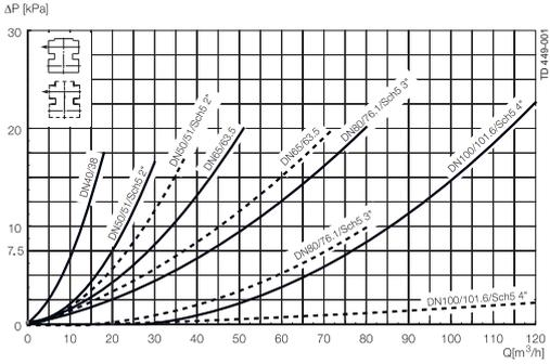
**Abb. 3, Druckabfall-/Leistungsdiagramm, oberes Gehäuse**
